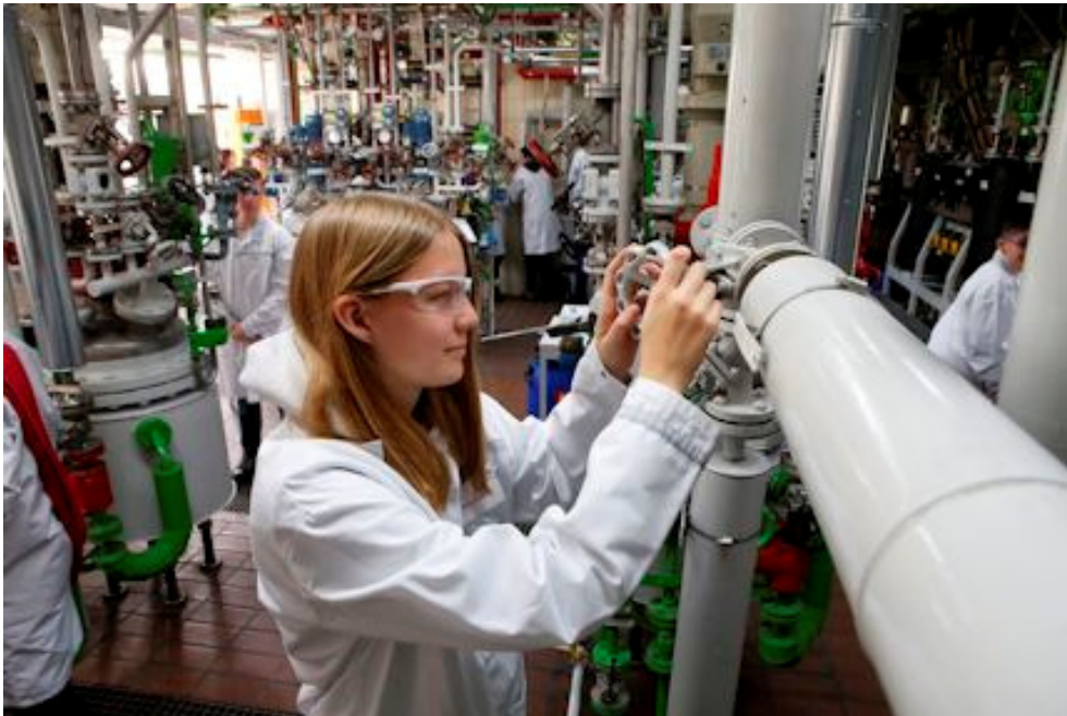
Schülerin Marlene bedient das Produkteinlaufventil im Provadis Technikum. © 2020 Provadis Partner für Bildung und Beratung GmbH
