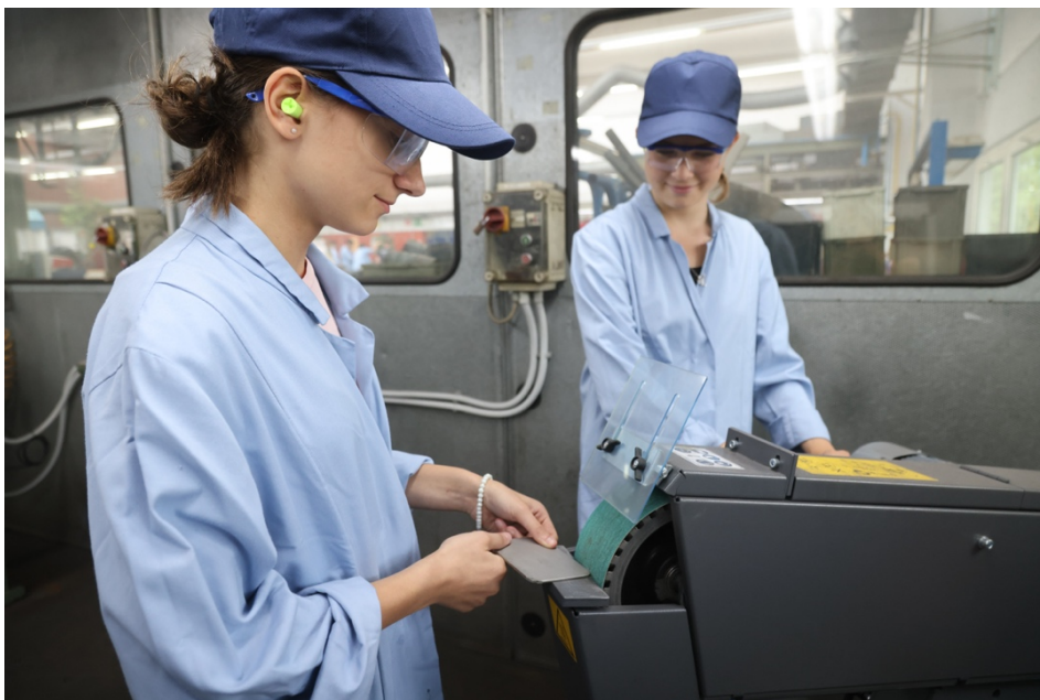
Premiere beim Zukunftsprojekt Wärmepumpe: Laetizia Jakobi (links) und Lena-Marie Frank bearbeiten in der Werkstatt bei Provalids mit der Schleifmaschine eine Eisenplatte. © 2023 Provalids Partner für Bildung und Beratung GmbH
